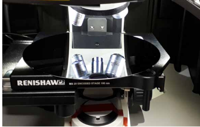
Analyse eines 200 mm Si-Wafers mit 100 nm Positioniergenauigkeit
