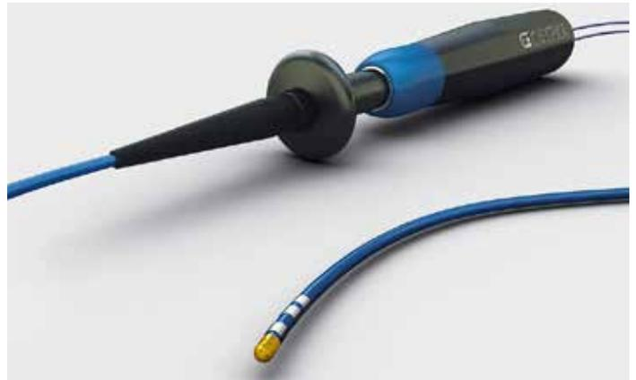
*Katheter, in denen mikromechanische Ultraschallwandler des Fraunhofer IPMS integriert sind, bieten eine bessere Funktionalität, sind kleiner, billiger herzustellen und einfacher zu bedienen.*
