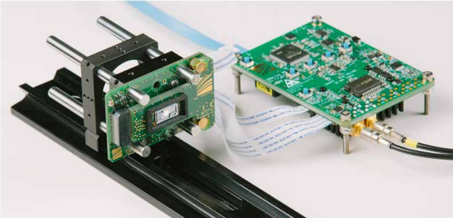
Mit dem ResoLin-Evaluation-Kit »QSDrive Scan Kit« bietet das Fraunhofer IPMS seinen Kunden ab sofort die Möglichkeit, kostenschonend und flexibel statisch auslenkbare MEMS-Scannerspiegel für Anwendungen zu erproben, die mit den verbreiteten resonant schwingenden Mikroskannern bislang nicht zufriedenstellend bedient werden konnten.
