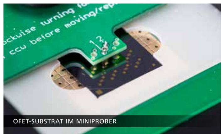
Auf den lediglich 0,5 mm × 0,5 mm großen Kontaktpads kann so eine sehr sichere Kontaktierung erfolgen. Weitere Varianten des Miniprobers bezüglich der Anschlüsse, sowohl der Lage als auch der Anzahl, sind möglich. Insofern ist der Miniprober nicht nur auf den Einsatz für OFETs beschränkt. Die Weiterleitung der Messsignale erfolgt mit BNC- bzw. Triaxkabeln bis zum Messgerät.
