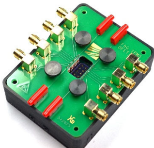
Neuer Messadapter für die gleichzeitige Kontaktierung von bis zu acht Interdigitalelektrodenpaaren ©Fraunhofer IPMS
