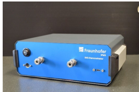
Labordemonstrator als Ionenmobilitätsspektrometer basierend auf einem speziellen IMS-Chip. ©Fraunhofer IPMS
