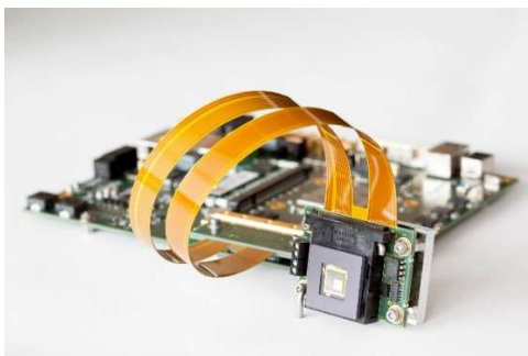
Customer Evaluation Kit mit Steuerelektronik, Verbindungskabel und 256 x 256 Spiegel- Bauelement © Fraunhofer IPMS
