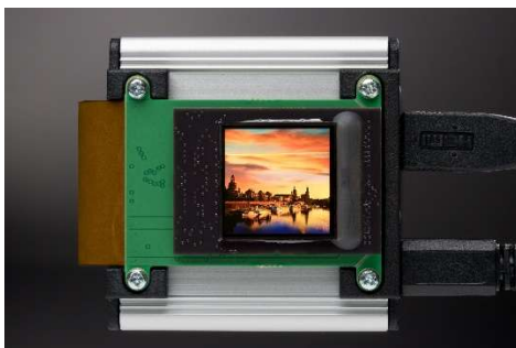
OLED-Mikrodisplay mit 2K-Auflösung (2048 x 2048 Pixel, 1.07 Inch)
