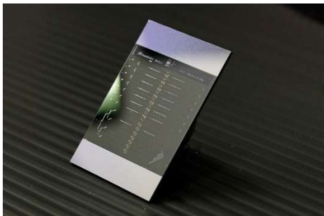
Mittels Integrated Photonics miniaturisierter photonischer Biosensor-Chip des Fraunhofer IPMS.
