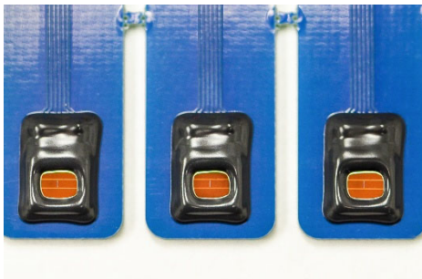
Als ISFET oder REFET verfügbare Chips des Fraunhofer IPMS, gebondet und verkapselt auf FR4-Platine ©Fraunhofer IPMS
