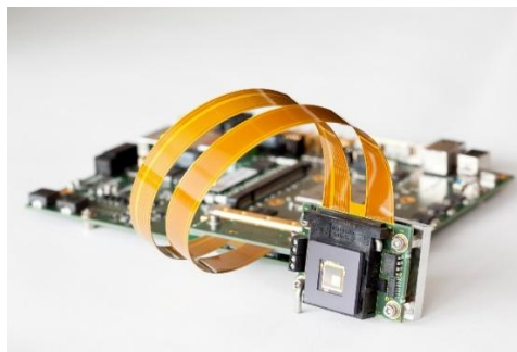
Customer Evaluation Kit mit Steuerelektronik, Verbindungskabel und 256 x 256 Spiegel-Bauelement
