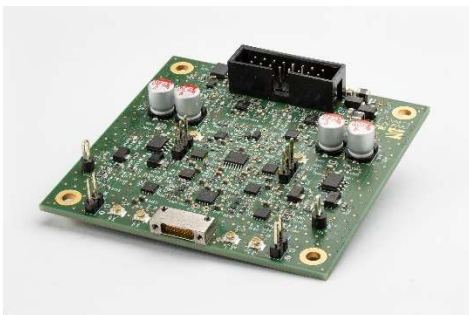
Antriebselektronik für elektromagnetische Vektorscanner. © Fraunhofer IPMS
