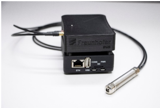
Evaluationskit als Versuchsschaltung von miniaturisierten kapazitiven mikromechanischen Ultraschallwandlern (CMUTs) beim Kunden © Fraunhofer IPMS
