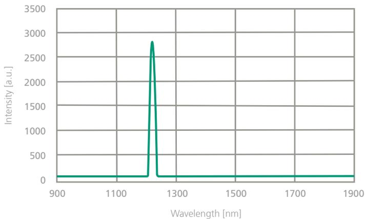
Gemessene spektrale Auflösung des Scanning Mirror Mikrospektrometers von ca. 10 nm
