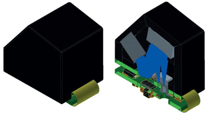
Entwurf des Scanning Mirror Mikrospektrometers (SMMS)
